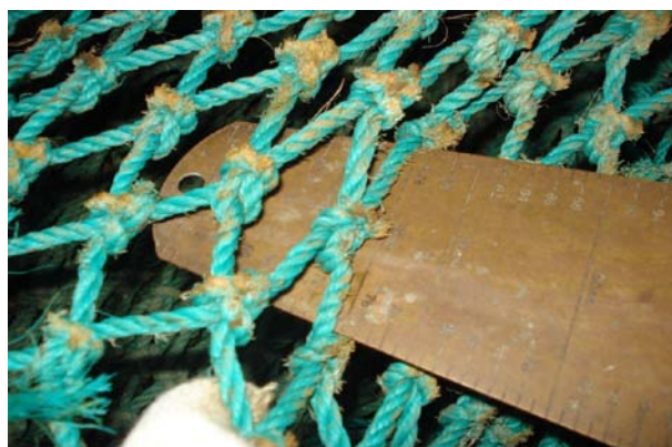
Image 6-6 Mesure de l'ouverture de maille étirée de l'intérieur des nœuds (en haut à gauche ; modifié à partir de Ferro et Xu 1996) en utilisant une jauge triangulaire (en haut à droite ; Fonteyne et al. 2007). Image du bas fournie par S. Sei (Sierra Leone).
