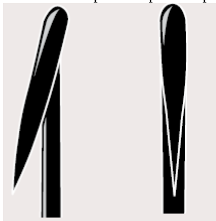
Image 8-6 Hameçons à courbure désaxée (gauche) et à courbure dans l'axe. Image tirée de Beverly (2009).
