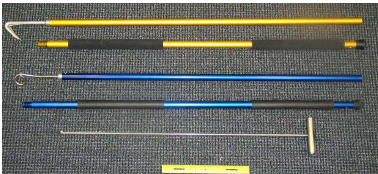
Image 16-1 Équipement à long manche : Coupe-lignes (au dessus), dispositif d'extraction en queue de cochon (au milieu) et dispositif en J (en bas). Images extraites de PIRO (2009).
