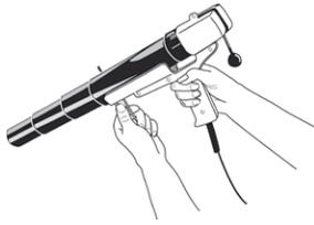
niveaux de profondeur. L'information est utilisée pour trouver des thermoclines, des fronts océaniques ou des courants de Foucault, indiquant la présence de poissons, en particulier les thons. Les navires peuvent disposer de XBT automatisés ou à commande manuelle. L'utilisation d'un XBT par un navire se traduit par le déploiement régulier d'une sonde.
